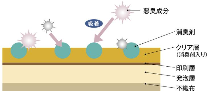
表面に加工している消臭剤が、臭気ガスとの化学反応による吸着をすることで、消臭効果が得られる仕組みになっています。
