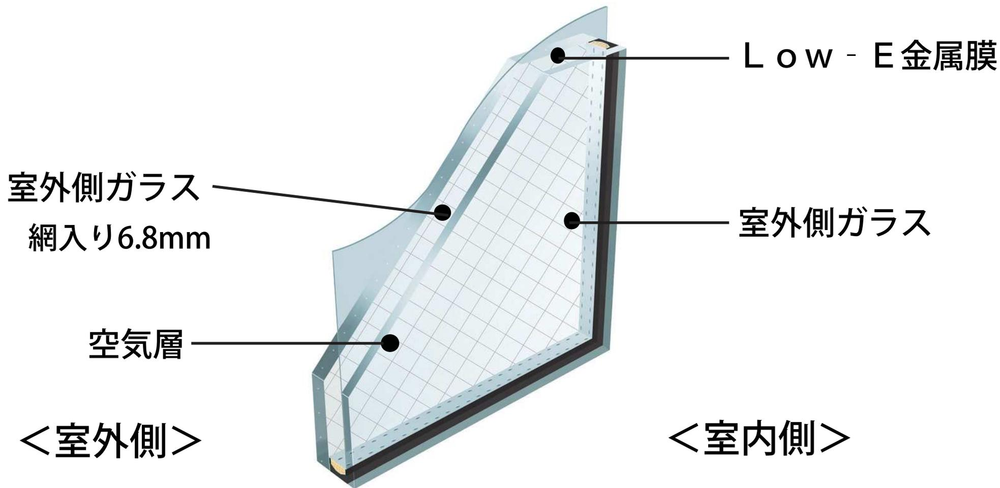
室内側ガラスを Low-E 金属膜でコーティングすることによって暖かい太陽光を取込み、室内の暖房熱を逃がさない複層ガラスです。
